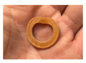
通水後に面倒な機器周りで漏水すれば、パッキン交換だけで一苦労なので、フレキの袋ナットを締める前に少し気にしてみてください。
